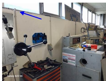
Matériaux : ZPSO-008 Prélèvement : P010 Description : Bandes calicot Localisation : RDC - Atelier Résultat : Absence d'amiante
